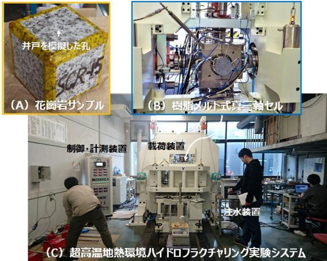
図 1: 超高温地熱環境ハイドロフラクチャリング実験システムと実験風景。本実験システムは、立方体状の岩石サンプル(写真 A)を格納する樹脂メルト式真三軸セルと呼ばれる特殊な高温対応耐圧容器(写真 B)と、このセルとともに使用して岩石の加熱加圧を行う载荷装置や制御・計測装置、そして岩石に注水するための注水装置などから構成されています(写真 C)。
