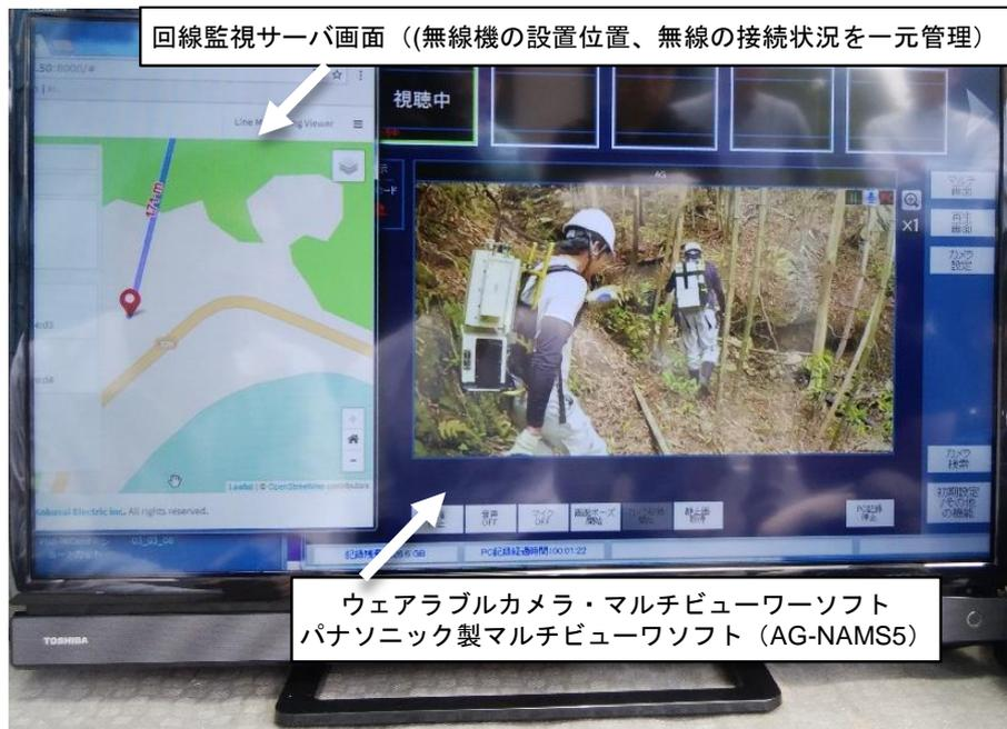
図9 伝送された映像 (基地局-移動局間1対1接続時)
