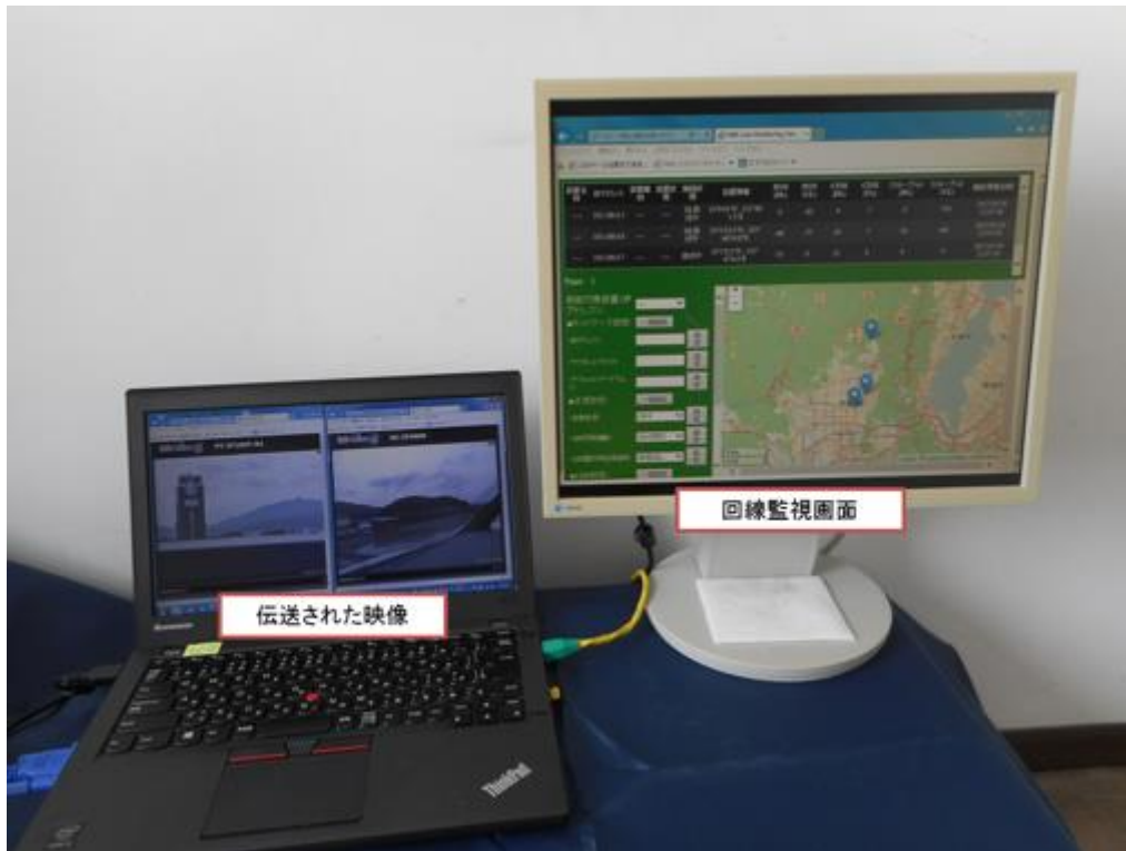
図 4 京都市役所基地局でのモニタ画面（端末局で撮影された映像だけでなく、中継局で撮影されたリアルタイム映像を同時に基地局に伝送）地図出典：© OpenStreetMap contributors ( http://www.openstreetmap.org/ )
