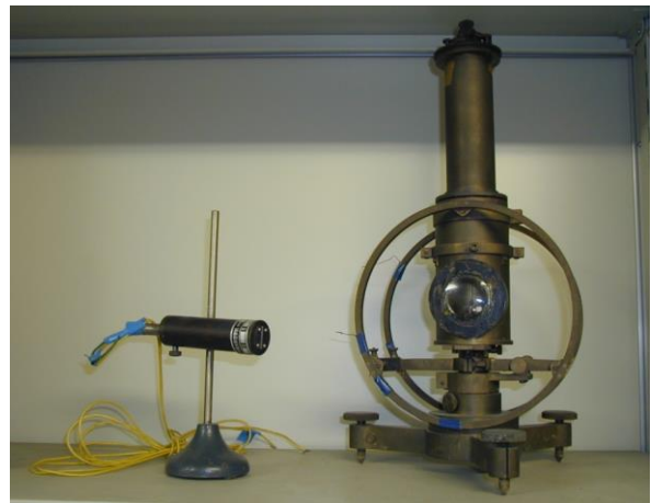
図2：(左)古い時代の地磁気観測の原理。磁石を細い糸で吊り下げ、光を反射させて印画紙に記録していた。(右)京都大学で作成・使用されていた光学記録式磁力計の写真。
