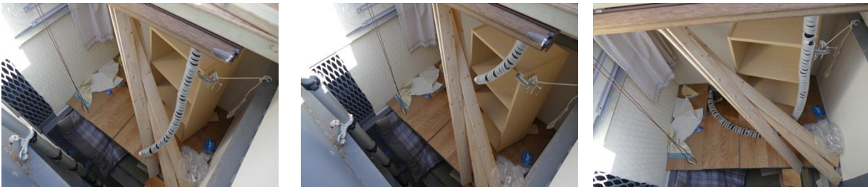
図4 熊本地震の倒壊木造家屋の内部を模擬した瓦礫空間への能動スコープカメラの進入
