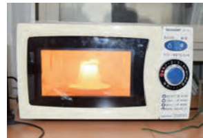
←電子レンジのマイクロ波を用いてプラズマを生成することができます。プラズマは非線形性と呼ばれる物理的な性質を持ちます。
