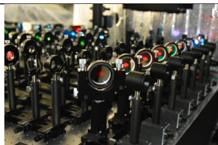
(写真 1) 自家製の生細胞内 1 分子追跡用ステーション 生細胞中で多数の蛍光標識分子を 1 分子分解能で追跡するため、膜協同性ユニットが特別に組み立てた顕微鏡
