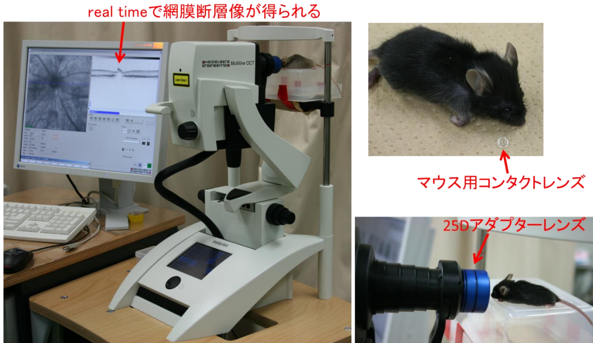
図4 光干渉断層計（OCT: optical coherence tomography） 眼科診療で汎用される光干渉断層計を実験動物用に改良し、イメージングを行っている。
