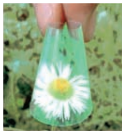
写真5 ナタデココで補強した曲げられる透明シート
