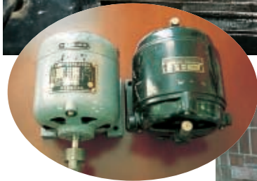
↑メカと電気で動くハイブリッドタイプの駆動装置は、ドイツの電気機器メーカー、シーメンス社が製作した。黒いモーターはシーメンス社製、灰色のモーターは、のちに使用された国産品。当初から誤差年間1秒以内という精度だった。
