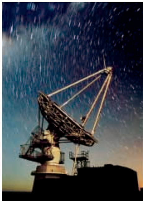
オーストラリアに設置された高エネルギー天文台の直径10メートルの望遠鏡。この観測で、天体における高エネルギー現象の研究を行なう。提供・東京大学宇宙線研究所
