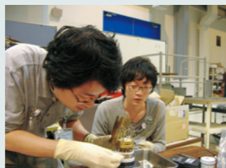
【写真】 課題研究における実験。放射光を利用した流体金属のコンプトン散乱実験で、試料の加熱機構を院生がセットしている様子。
